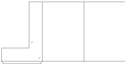
Stanzform 015: 220x315mm, 1 Klappe, 1 Klebelasche, Visitenkartenschlitze
